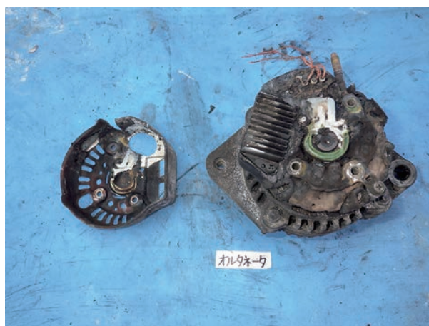
写真 6-13-2 オルタネータの焼損状況
