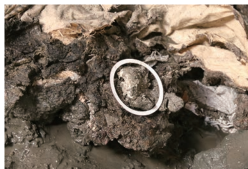
写真 3-2-2 生石灰の状況
