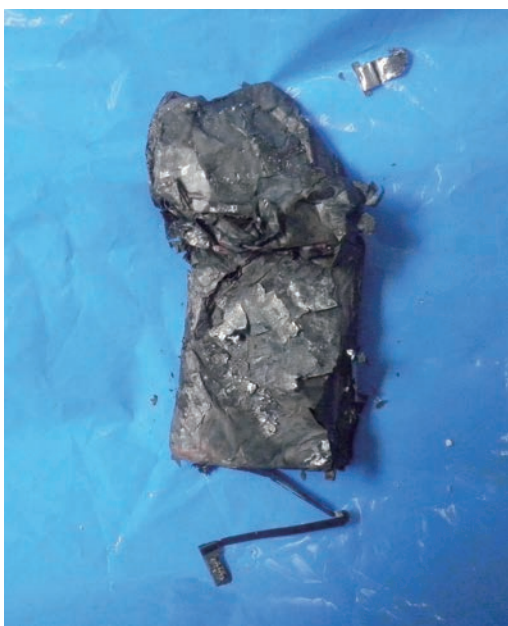
写真 2-6-4 焼損したスマートフォンの状況
