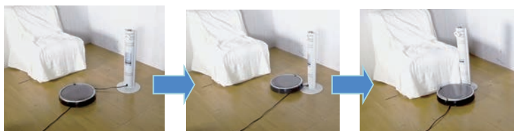
写真 2-6-3 電気コードによる電気ストーブの移動
