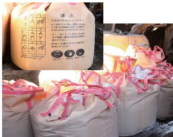
写真 3-2-3 生石灰の保管状況と注意書き
