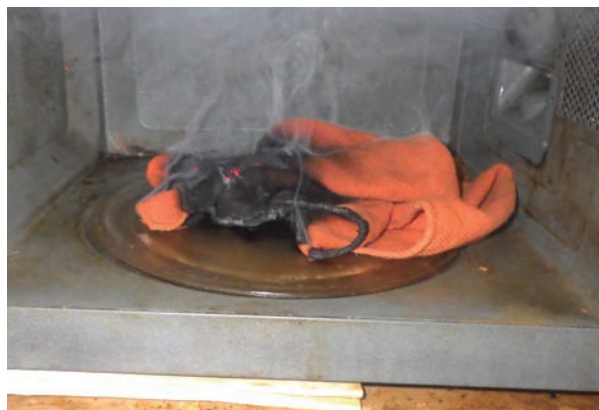
写真 5-1-2 焼損した布巾の状況
