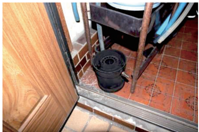
写真 2-8-2 玄関に置かれた石油ストーブの燃焼筒
