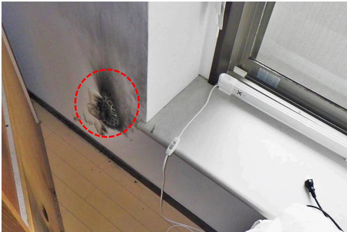
⑨家具背面にあるマルチタップの トラッキングにより出火した火災（4月）
