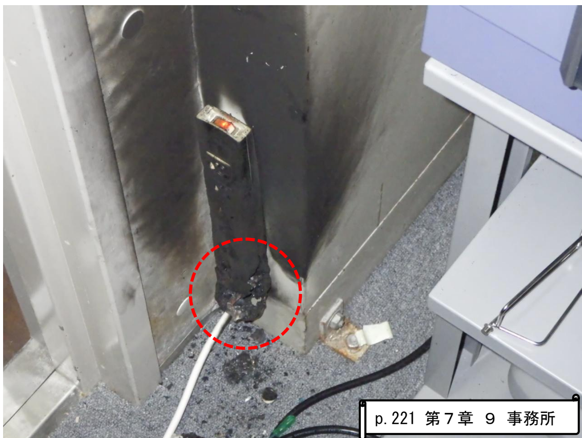
②テーブルタップのトラッキング により出火した火災（8月）
