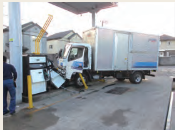
2tトラックが固定給油設備に衝突した状況
