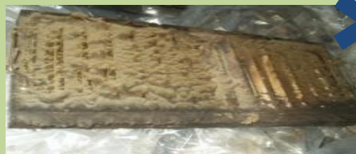
フィルターが目詰まりした状態
