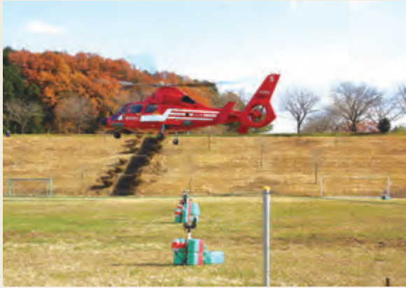
▲ 大型ヘリコプターがホバリング時に発生させるダウンウォッシュの風速測定に関する検証
