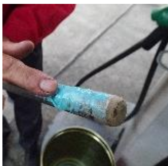
検水棒等の先端にウォーターリボンを塗布
