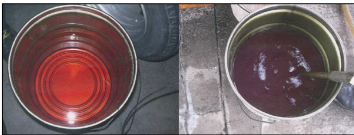
左：正常なガソリン 右：水が混入したガソリン
