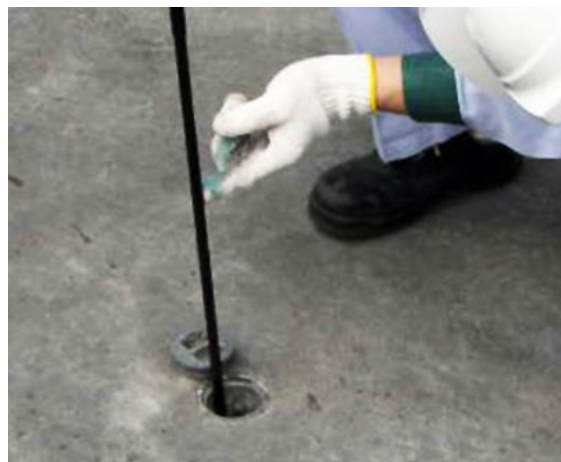
漏えい検査管に検知棒を挿入して油漏れを点検する状況 【出典】全国危険物安全協会（写真右）
