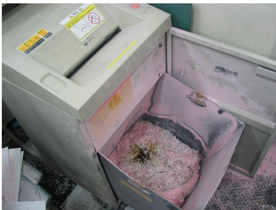
写真3 焼損したシュレッダー内の状況
