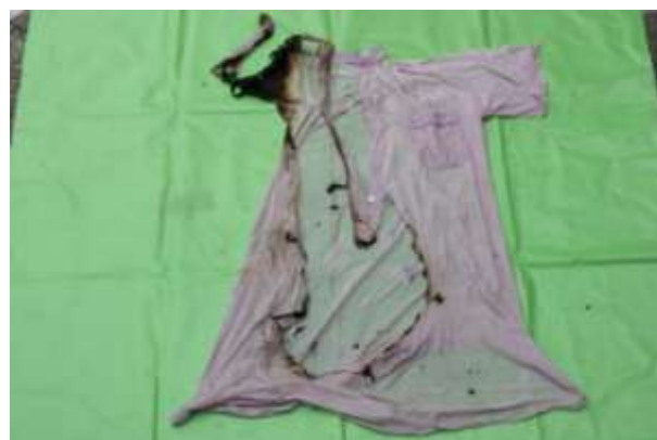
写真 1 - 2 焼損した衣類の状況
