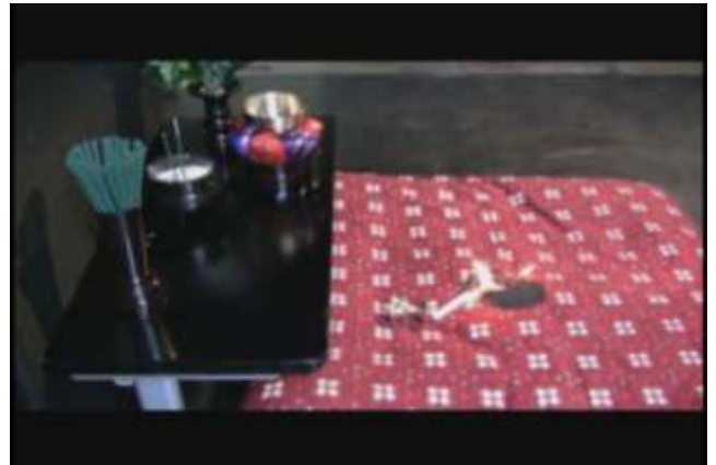
2 灯明が転倒して座布団に着火した状況
