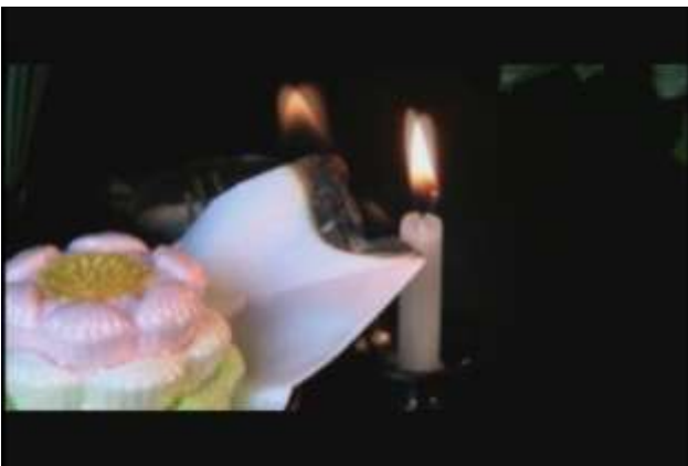
3 灯明が時間経過とともに短くなり 可燃物に着火した状況
