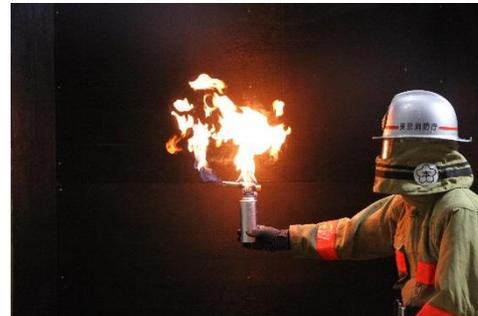
ナ本体が炎に包まれました。女性は火を消そうとしましたが、なかなか消えず、最後は風呂の浴槽に投げ込み、濡らしたバスマットを覆い被せて消火しました。この火事により、女性は熱傷を負いました。古いガスボンベを使用したために、取り付け部からガスが漏れたものと判明しました。
