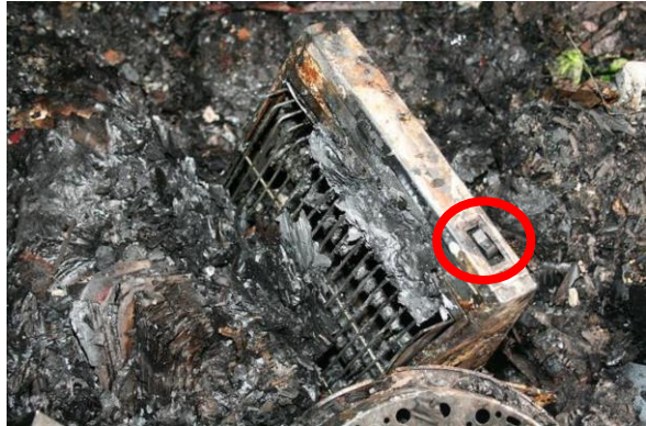
写真3-2 電気ストーブの焼損状況
