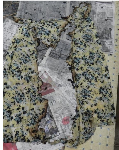
写真1-1 着衣の焼損状況
