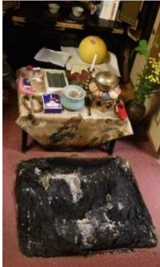
写真1-1 座布団の焼損状況
