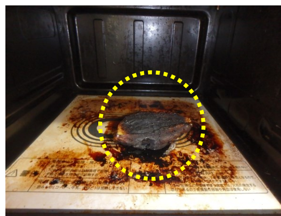
写真4 焼損したさつま芋の状況
