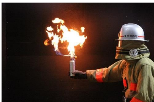
(事例2) 取り付け部からのガス漏れ引火
