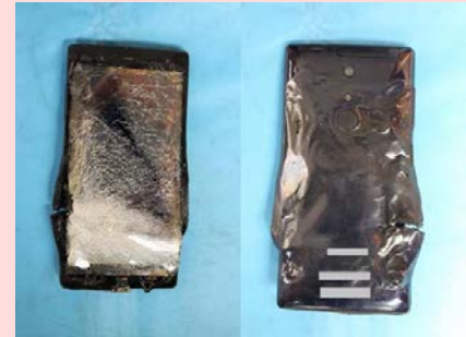
衝撃で破損したリチウムイオンバッテリー
