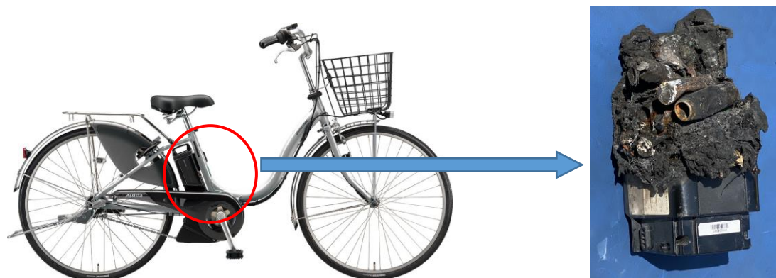
焼損したバッテリー
