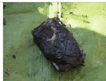
潰れて燃えた充電式電池
