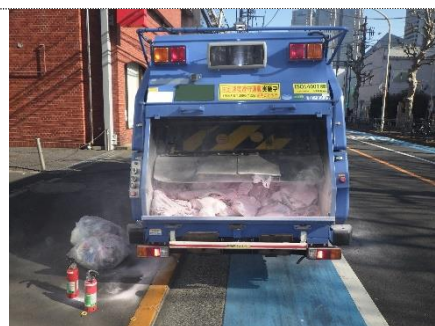
焼損した清掃車
